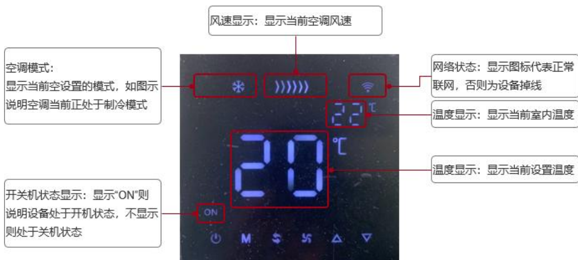
空调控制页面显示
