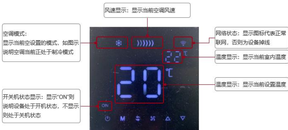
空调控制页面显示
